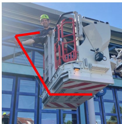
Drahtseilführung unter dem Korb, wenn FW-Angehöriger zur Einsatzstelle gefahren wird
