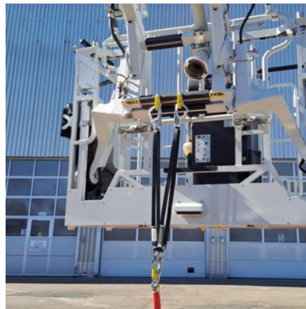
Universaladapter (seit 2025) an der Leiterspitze einer Magirus SC Drehleiter
