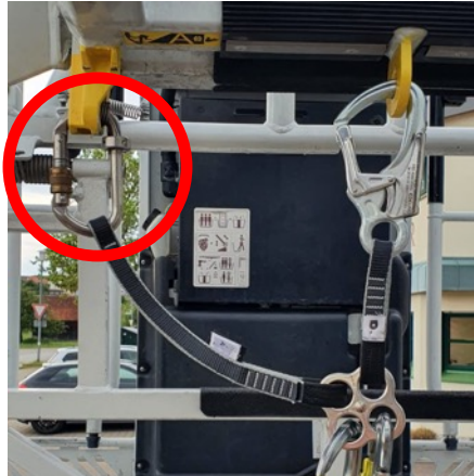
Bei älteren Magirus Drehleitern ist der seitliche Ovalekarabiner bereits fest verbaut, dort wird die freie Schlinge eingehängt
